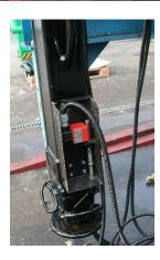
2. Sind die Abstützungen und Ausschubkästen in Fahrstellung, leuchtet im Fahrerhaus eine grüne Kontrolleuchte.
