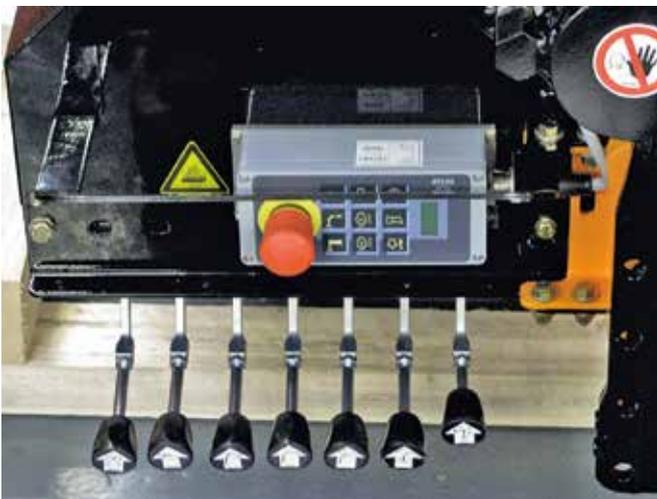
EL – HMS Handhebelsteuerung, Optional
