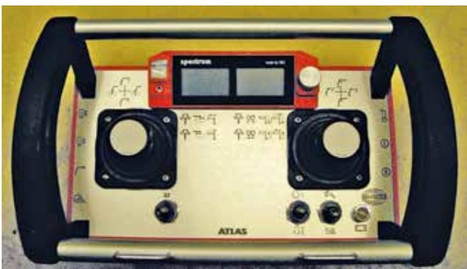
Spectrum 2 – mit 2 Kreuzhebel / Drehkopf und Display \*
