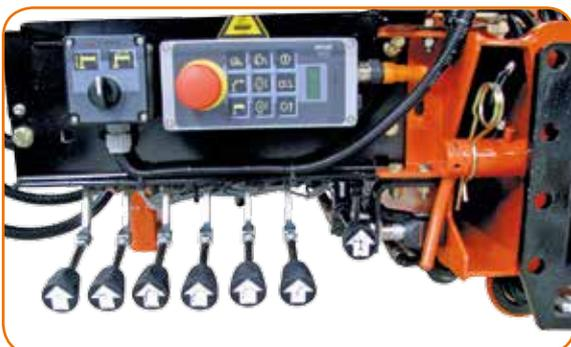
Unterflursteuerung Standardausführung, direkt am Kran.
