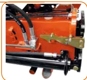
**Leichte Bedienung des Sicherungsfallhakens, für die seitliche Verriegelung des Abstützträgers. Easy operation of the safety hook for the lateral latching device of the outrigger support.**
