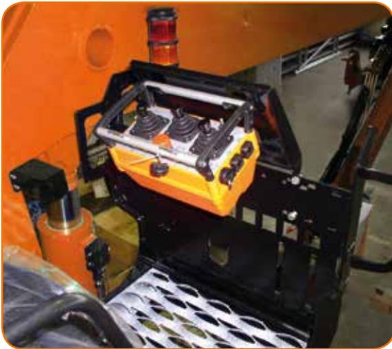
Sitz für Funkfernsteuerung, ermöglicht ein ermüdungsfreies und feinfühliges Arbeiten. Beheizbare Sitzschale auf Wunsch.
