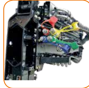
Schnellverschluss- kupplungen zum schnellen Wechseln von Werkzeugen. Quick-release couplings for quick tool changes.
