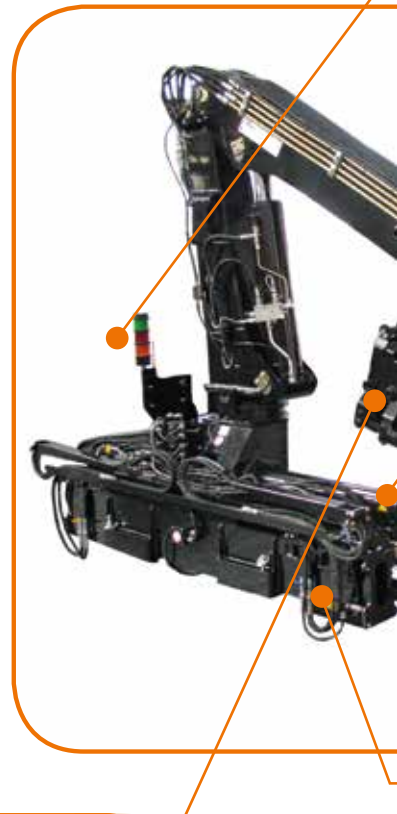
Greiferkopfstück, schnell montierbar. Quickly mountable grab head piece.
