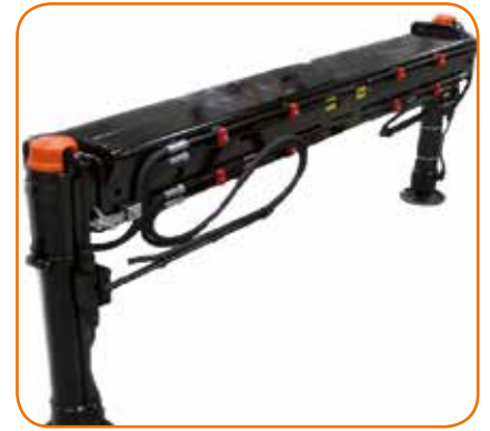
Zusatzabstützträger Additional outriggers
